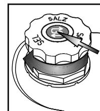
Vissez le bouchon. Éliminez les résidus de sel autour du bouchon. Certains réservoirs à sel ont un indicateur de niveau intégré dans le bouchon (voir comment contrôler ci-dessous).
