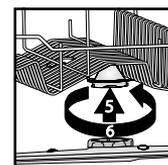
Insérez et serrez à fond les bras d'aspersion inférieur et supérieur.
