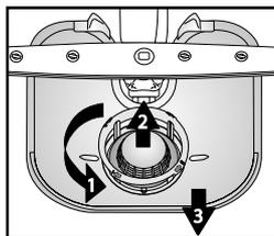
Dévissez le microfiltre (1), déposez-le (2) et retirez le filtre à petits grains (3)...
