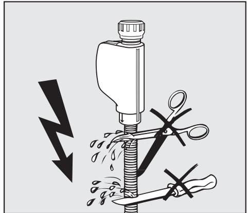
⚡ Le tuyau d'arrivée ne doit **pas** être raccourci ou abîmé étant donné qu'on y trouve des éléments sous tension (voir croquis).
