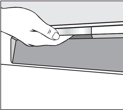
La porte est automatiquement entrouverte à la fin des programmes comportant une phase de séchage (voir le tableau des programmes) afin d'améliorer le séchage.
