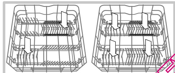
O cesto dos talheres pode ser de tipo diferente, decomponível ou não decomponível, conforme o modelo da máquina de lavar louça. O cesto não decomponível deve ser posicionado **somente** na parte anterior do cesto inferior.
