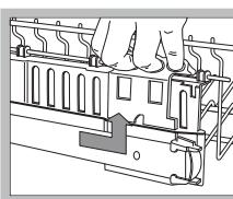
Розкрийте стопори на правій та лівій напрямній коробу та вийміть короб; розташуйте його у верхньому або нижньому положенні, посуньте по напрямних, щоб зайшли також передні коліщата, після чого закрійте стопори (див.малюнок).
