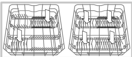
Koszyki na sztućce mogą być różnego typu, składane i nie składane, w zależności od modelu zmywarki. Kosz nieskładany może być umieszczony **wyłącznie** w przedniej części dolnego kosza.
