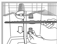
Aby zdementować górnego spryskiwacza należy odkręcić plastikowy pierścień, obracając go w kierunku przeciwnym do ruchu wskazówek zegara. Górnego zraszacz należy zamontować z otwarami skierowanymi do góry.
