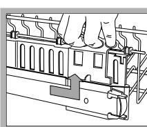
Abra los sujetadores de las guías del cesto, hacia la izquierda y hacia la derecha y extraiga el cesto; colóquelo arriba o abajo, hágalo deslizar a lo largo de las guías hasta hacer entrar también las ruedas delanteras y cierre los sujetadores (*ver la figura*).
