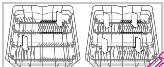
Le panier à couverts peut varier selon le modèle de lave-vaisselle et être séparable ou non séparable. Le panier à couverts non séparable doit être placé **obligatoirement** dans la partie avant du panier inférieur.
