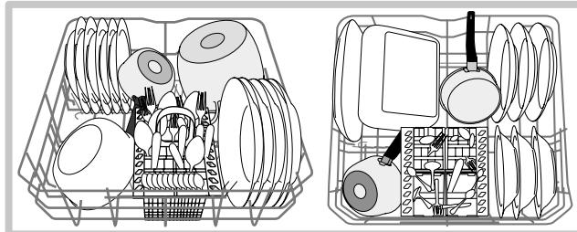
Einige Geschirrspülermodelle verfügen über klappbare Bereiche\*, die in senkrechter Stellung zum Einstemmen von Tellern oder in waagerechter Stellung zum Einräumen von Töpfen, Schüsseln und Pfannen verwendet werden können.
