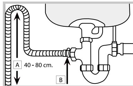
Przewód odprowadzający musi znajdować się na wysokości od 40 do 80 cm od podłogi lub podłożu, na którym umieszczono zmywarkę (A).
