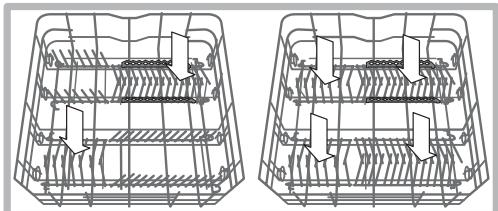
Кошик для приборів може різнятися (належати до розбірного чи нерозбірного типу) залежно від моделі посудомийної машини. Нерозбірний кошик має розташовуватися тільки у передній частині нижнього коробу.
