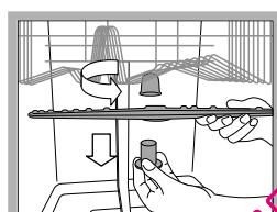
Para desmontar o aspersor superior deve-se desapertar girando o anel de plástico na direcção anti-horária. O braço aspersor superior deve ser remontado com os furos para cima.
