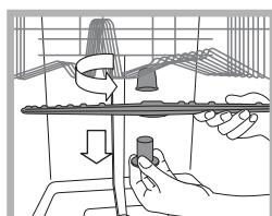
Щоб зняти верхній розпилювач, слід розгвинтити проти годинникової стрілки пластикову круглу гайку. При встановленні верхнього розпилювача поверніть догори частину з більшою кількістю отворів.
