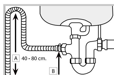
Der Ablaufschlauch muss sich in einer Höhe von 40 bis 80 cm vom Boden oder von der Standfläche der Spülmaschine (A) befinden.
