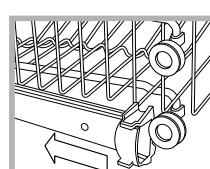
Öffnen Sie die rechte und linke Arretierung der Korbführungen und ziehen Sie den Korb heraus; schieben Sie ihn in Hoch- oder Niedrigstellung ein; lassen Sie ihn über die Führungen gleiten, bis auch die Vorderräder eingeschoben sind, und schließen Sie die Arretierungen (siehe Abbildung).
