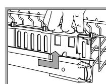
Ist der Korb mit **Dual Space\***-Griffen ausgestattet (siehe Abbildung), ziehen Sie den Oberkorb bis zum Anschlag heraus, fassen die an den Korbseiten befindlichen Griffe mit den Händen, ziehen diese nach oben bzw. drücken sie nach unten und lassen den Korb darauf hinab (hierbei festhalten).
