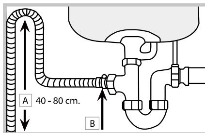
O tubo de descarregamento deve estar a uma altura entre os 40 e os 80 cm do piso ou do plano de apoio da máquina de lavar louças (A).
