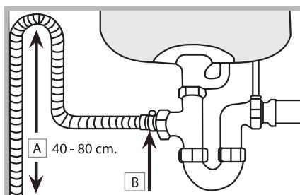
Зливний шланг має розташовуватися на висоті від 40 до 80 від підлоги або опірної поверхні посудомийної машини (A). Перш ніж під'єднати зливний шланг до сифону мийки, видаліть пластикову пробку (B).
