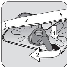
**6** Remettez le système de filtre en place. Pour verrouiller le système de filtre, tournez la poignée dans le sens des aiguilles d'une montre jusqu'à ce qu'elle se verrouille.
