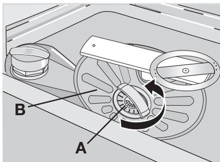
2. Le filtre (A) est composé de 2 pièces. Pour démonter le filtre, séparez-les.
