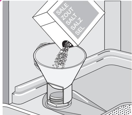
**i** Il est normal que de l'eau s'écoule du réservoir lorsque vous le remplissez de sel.
