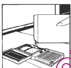
Der Spülmittelbehälter befindet sich auf der Innenseite der Tür. Er ist durch leichtes Drücken einfach zu öffnen. Der Deckel des Spülmittelbehälters muss vor jedem Spülgang geschlossen werden. Er bleibt am Ende des Spülprogrammes stets offen und ist somit sofort wieder benutzbar. Die Spülmitteldosis kann je nach Verschmutzungsgrad und Spülprogramm variieren. Zu empfehlen sind 15 gr Spülmittel.
