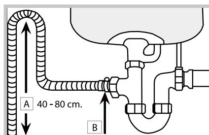
Der Ablaufschlauch muss sich in einer Höhe von 40 bis 80 cm vom Boden oder von der Standfläche der Spülmaschine (A) befinden.
