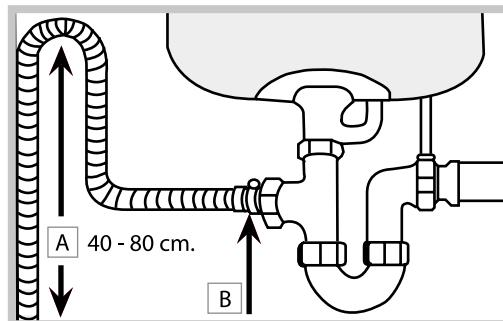
De afvoerslang moet zich op een hoogte tussen de 40 en 80 cm van de vloer of het steunvlak van de vaatwasser (A) bevinden. Verwijder de plastic dop (B) alvorens de waterafvoerslang aan de sifon van de gootsteen aan te sluiten.
