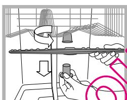
Zur Abnahme des oberen Sprüharms drehen Sie den Kunststoffring gegen den Uhrzeigersinn ab. Der obere Sprüharm ist mit nach oben gerichteten Löchern wieder einzusetzen.
