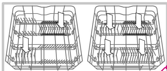
De bestekkorf verschilt aan de hand van het model afwasautomaat en kan of uit een deel bestaan of uit meerdere delen. Den nieuw demonteerbare korf mag **alleen** aan de voorzijde van het onderrek worden geplaatst.
