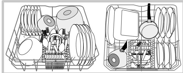
Algunos modelos de lavavajillas poseen sectores reclinables\*, los mismos se pueden utilizar en posición vertical para colocar los platos o en posición horizontal para colocar ollas, ensaladeras y sartenes.
