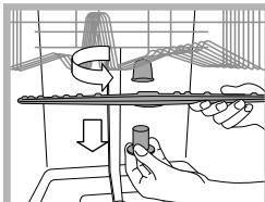
Pour démonter le bras supérieur, il faut dévisser la bague de fixation en plastique (tourner dans le sens inverse des aiguilles d'une montre). Il faut remonter le bras gicleur supérieur, orifices orientés vers le haut.
