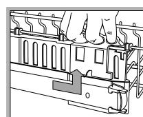
Ist der Korb mit **Dual Space**\*-Griffen ausgestattet (siehe Abbildung), ziehen Sie den Oberkorb bis zum Anschlag heraus, fassen die an den Korbseiten befindlichen Griffe mit den Händen, ziehen diese nach oben bzw. drücken sie nach unten und lassen den Korb daraufhin hinab (hierbei festhalten).
