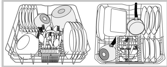
Einige Geschirrspülermodelle verfügen über klappbare Bereiche\*, die in senkrechter Stellung zum Einsortieren von Tellern oder in waagerechter Stellung zum Einräumen von Töpfen, Schüsseln und Pfannen verwendet werden können.
