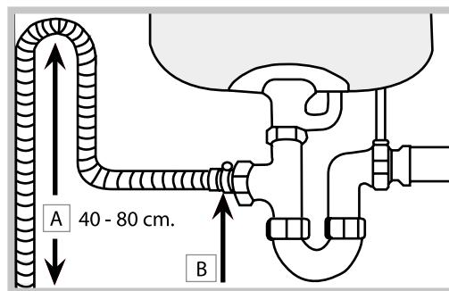
El tubo de descarga debe estar a una altura comprendida entre 40 y 80 cm. del piso o de la superficie de apoyo del lavavajillas (A).
