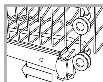
Öffnen Sie die rechte und linke Arretierung der Korbführungen und ziehen Sie den Korb heraus; schieben Sie ihn in Hoch- oder Niedrigstellung ein; lassen Sie ihn über die Führungen gleiten, bis auch die Vorderräder eingeschoben sind, und schließen Sie die Arretierungen (siehe Abbildung).
