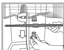
Per smontare l'irroratore superiore, occorre svitare girando in senso antiorario la ghiera di plastica. L'irroratore superiore va rimontato con la parte con il maggior numero di fori rivolta verso l'alto.
