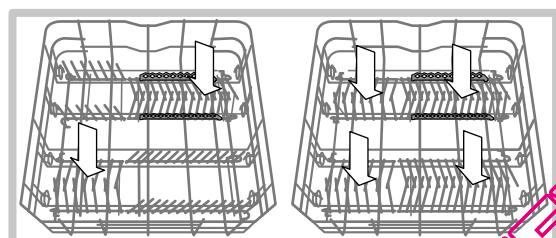
O cesto dos talheres pode ser de tipo diferente, decomponível ou não decomponível, conforme o modelo de máquina de lavar louça. O cesto não decomponível deve ser posicionado **somente** na parte anterior do cesto inferior.
