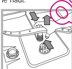
Pour démonter le bras de lavage inférieur, pousser sur les languettes situées sur les côtés et tirer vers le haut.
