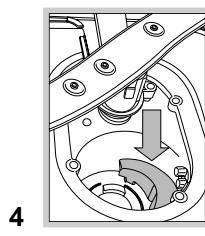
Após a limpeza dos filtros, monte novamente o grupo filtrante e coloque-o correctamente na sua posição; isto é fundamental para o bom funcionamento da máquina de lavar louças.
