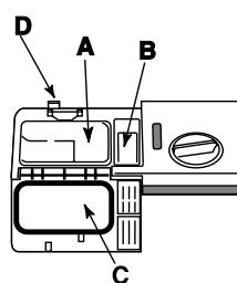
1. Öffnen Sie den Deckel C und drücken Sie die Taste D.
