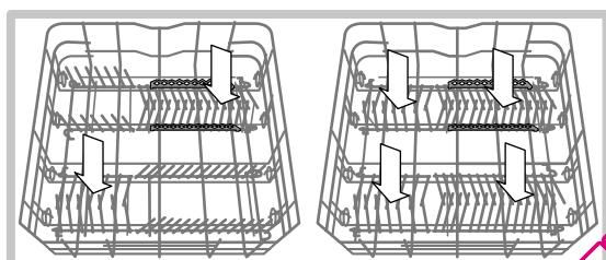
El cesto de los cubiertos puede ser descomponible o no según el modelo de lavavajillas. El cesto no descomponible se debe colocar **sólo** en la parte delantera del cesto inferior.
