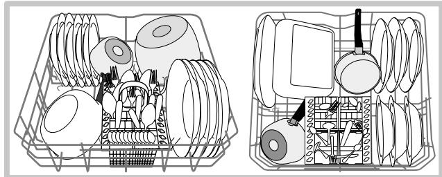
Alguns modelos de máquina de lavar louça dispõem de sectores reclináveis \*, estes sectores podem ser usados em posição vertical para posicionar os pratos ou em posição horizontal para posicionar panelas, tigelas e frigideiras.
