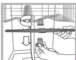
Om de bovenste sproeiarm uit elkaar te halen dient u de plastic dop linksom los te schroeven. De bovenste sproeiarm moet worden gedraaid met de gaten naar boven gericht.
